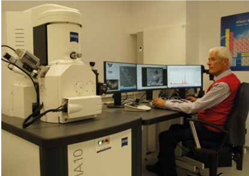
Bild 13: Rasterelektronen- mikroskop zur EDX-Analyse von Ausscheidungen und intermetallischen Pha- sen (Foto: Institut für Werkstoffuntersuchun- gen, Essen (D))
