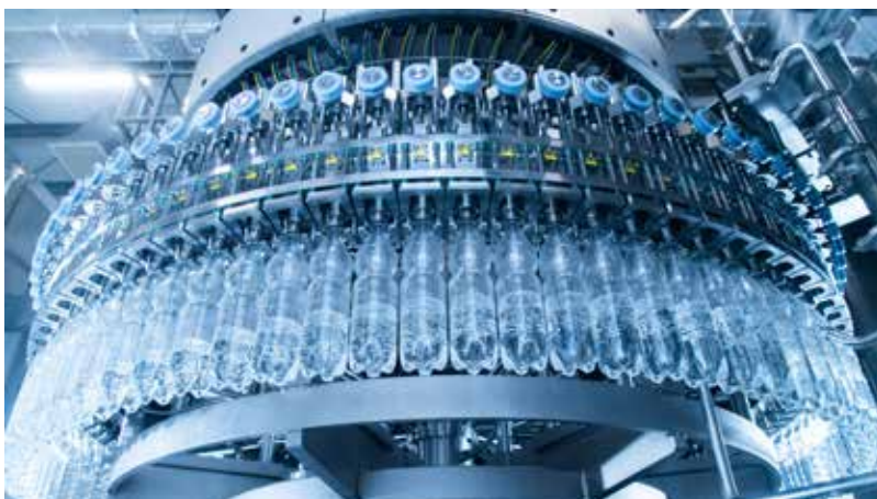
Abbildung 17: Flaschenabfüller unterliegen hohen hygienischen und mechanischen Anforderungen. Daher werden hier überwiegend nichtrostende Stähle eingesetzt.
