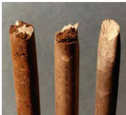
Abb. 7: Schweres Unglück im Hallenbad Uster (Schweiz) im Jahr 1985, bei dem wegen des Einsturzes der Zwischendecke zahlreiche Menschen zu Tode kamen. Ursache war Spannungsrisskorrosion an den Aufhängungsbügeln aus Cr-Ni-Stahl (CRC II). Die Oberflächen der gebrochenen Bügel zeigen unterschiedlich stark fortgeschrittene Korrosion. Der rechte Bügel zeigt eine starke Einschnürung mit typischer Gleitbruchfläche und hat vermutlich am längsten getragen. Beim mittleren Bügel ist eine geringe Einschnürung noch erkennbar.
